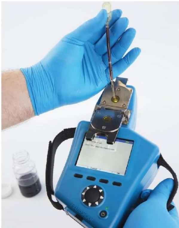
Запатентованная ячейка с откидной крышкой для точного и легкого анализа проб
